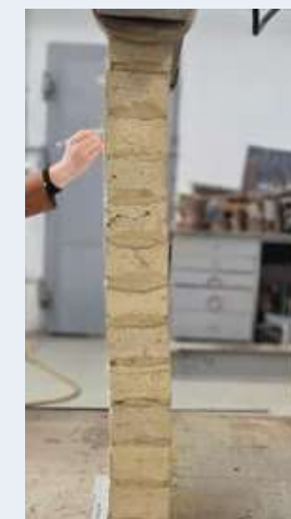
Fig 4 . Pierderea de stabilitate a zidăriei comprimate.
